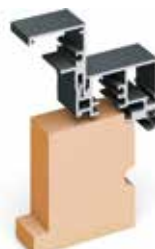
Oscillo coulissant : Tapée extérieure rapportée pour isolation de 80 à 190 mm sur l'ouvrant 69 mm
