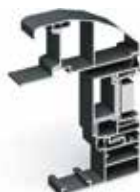
Dormant galandage 1 rail avec tapée rapportée en coupe d'onglet, isolation de 120 à 180 mm.
