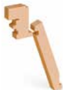
Tapée intérieure rapportée pour isolation de 200 mm
