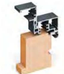
Oscillo coulissant : Tapée extérieure rapportée pour isolation de 80 à 190 mm sur l'ouvrant 69 mm
