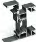
Dormant 2 rails avec tapée rapportée en coupe d'onglet, isolation de 100 à 180 mm.
