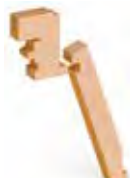
Tapée intérieure rapportée pour isolation de 200 mm
