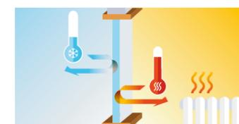
**Uw : Coefficient d'isolation thermique (unité :  $W/m^2.K$ ).** Il mesure la déperdition énergétique de la fenêtre (pour une porte on parle du Ud). C'est la capacité de la menuiserie à conserver la température intérieure. Plus sa valeur est faible, plus la menuiserie est isolante.
