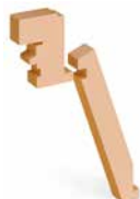
Tapée intérieure rapportée pour isolation de 200 mm
