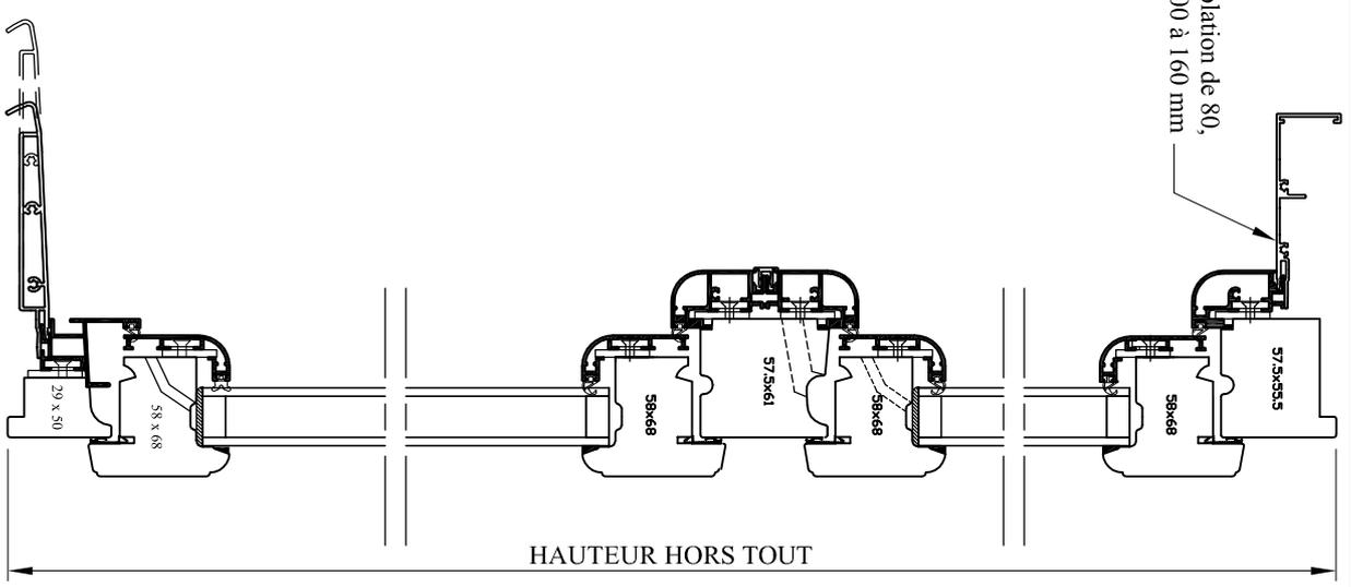
Sans tapée pour isolation de 80, avec tapée pour isolation de 100 à 160 mm
