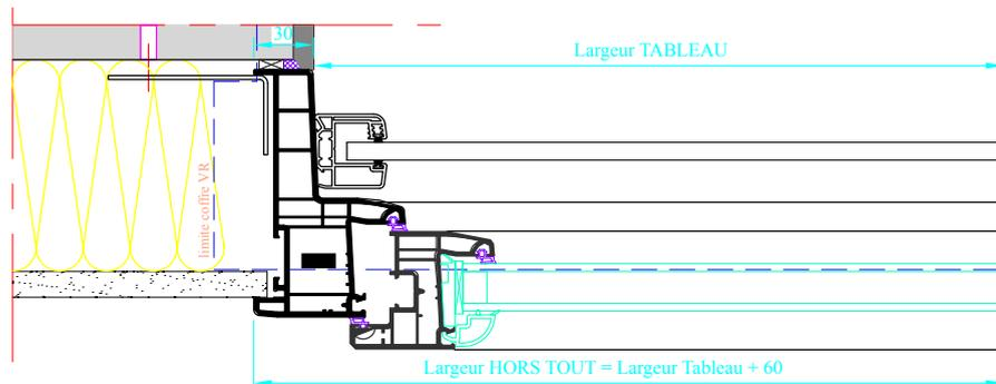
**⚠ Décaissé du linteau à indiquer lors de la commande : 110 mm**
